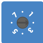
Draaischakelaar in positie 2
